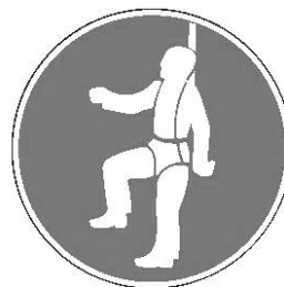
Работать в предохранительном (страховочном) поясе (M09)
