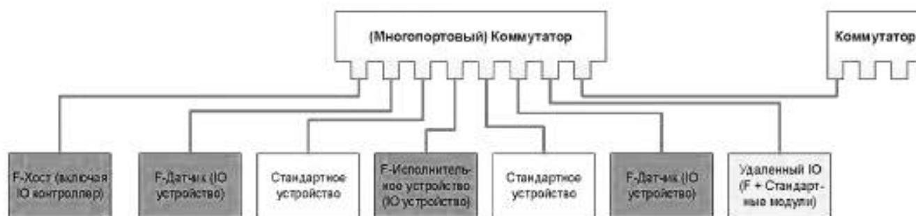
Рисунок 9 — Структура шины многоканального переключателя
