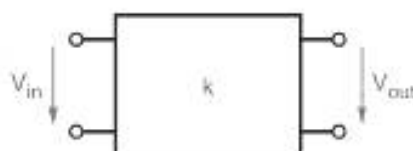
Рисунок 6 — Усилительный элемент четырехполюсника
