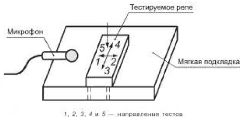
Рисунок 14 — Установка для теста излучения акустических шумов
