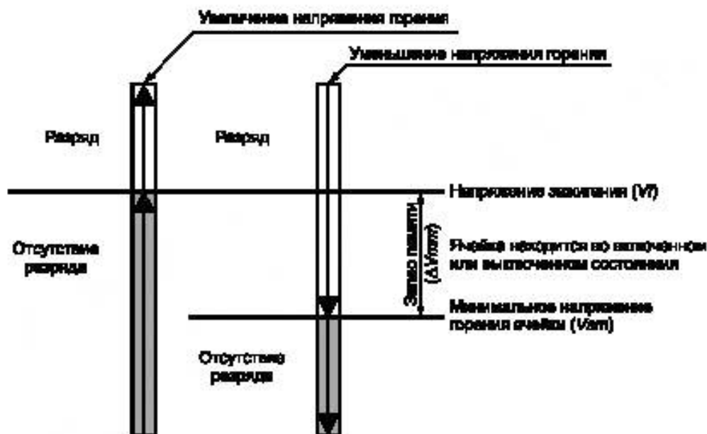
Рисунок А.2 — Разрядные характеристики ячейки (статические характеристики единичной ячейки)
