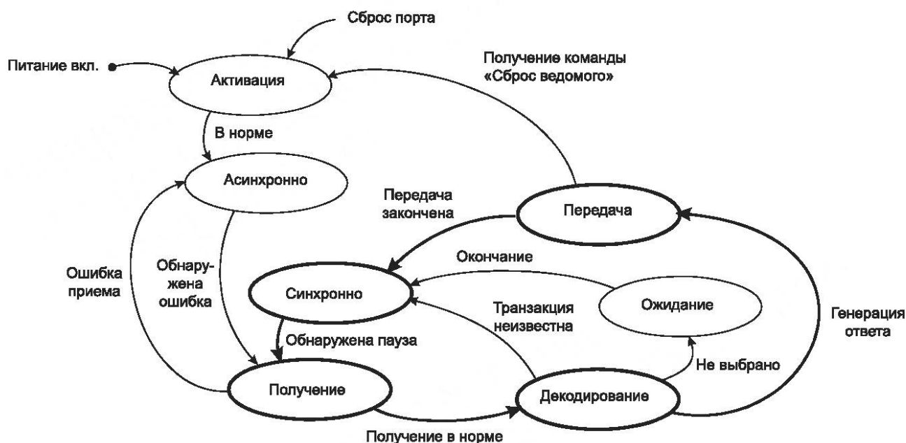
Рисунок 51 — Диаграмма основных состояний ведомого устройства AS-i
