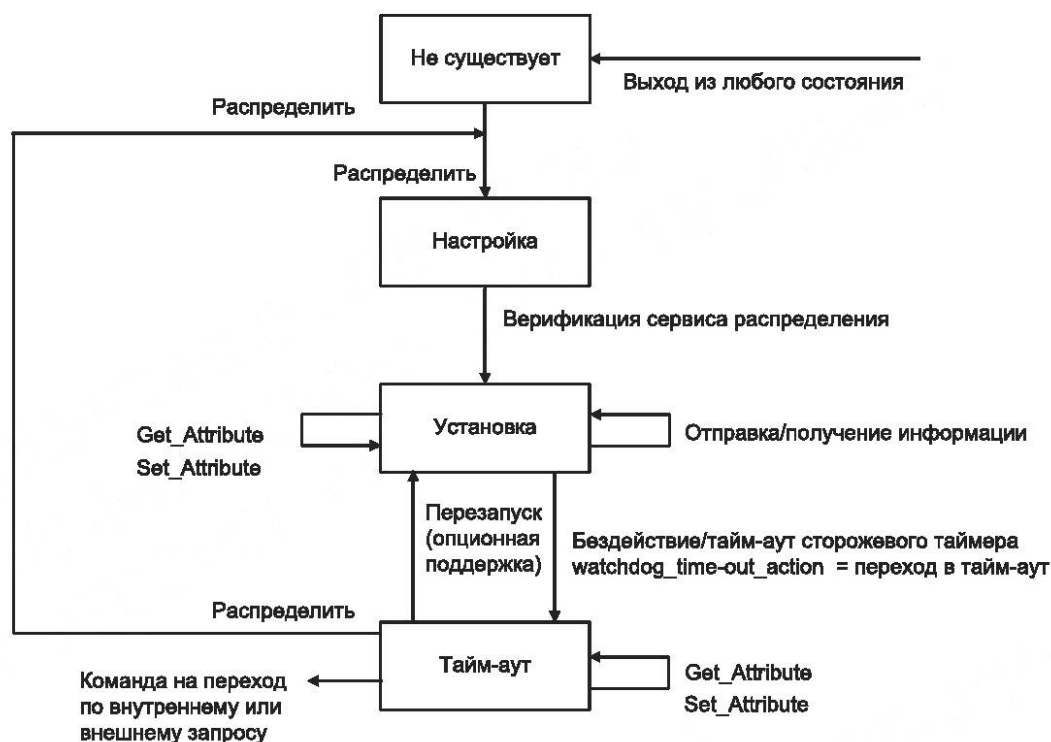
Рисунок 41 — Предопределенная диаграмма перехода состояния ввода-вывода «ведущий/ведомый»
