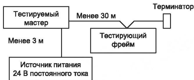
Рисунок 127 — Тестовая конфигурация для минимального трафика тестируемого мастера
