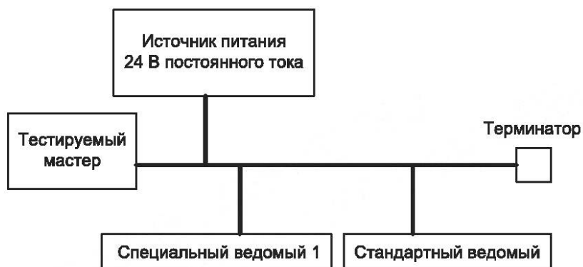
Рисунок 128 — Тестовая конфигурация для прокси-сервера ведущего тестируемого устройства
