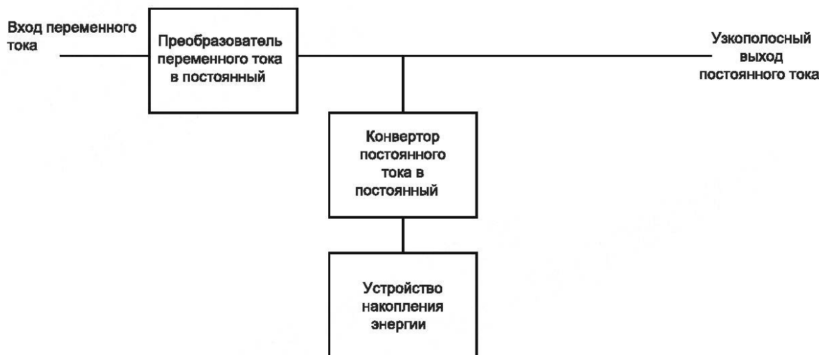
Рисунок В.3 — Линейно-интерактивная топология преобразования
