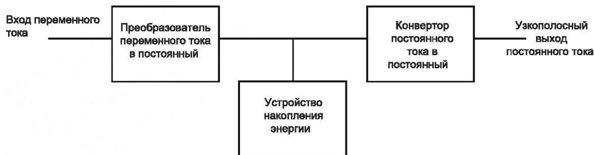
Рисунок В.2 — Топология двойного преобразования
