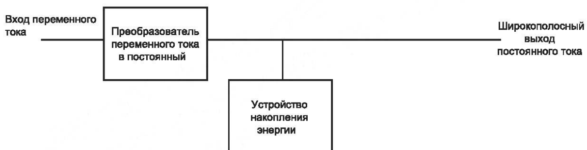
Рисунок В.1 — Прямое подключение к источнику энергии
