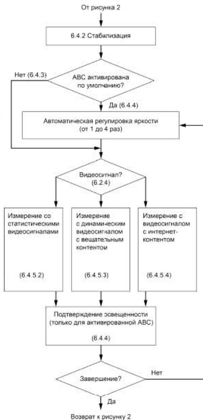
Рисунок 5 — Последовательность действий при определении потребления энергии в режиме «Вкл.»
