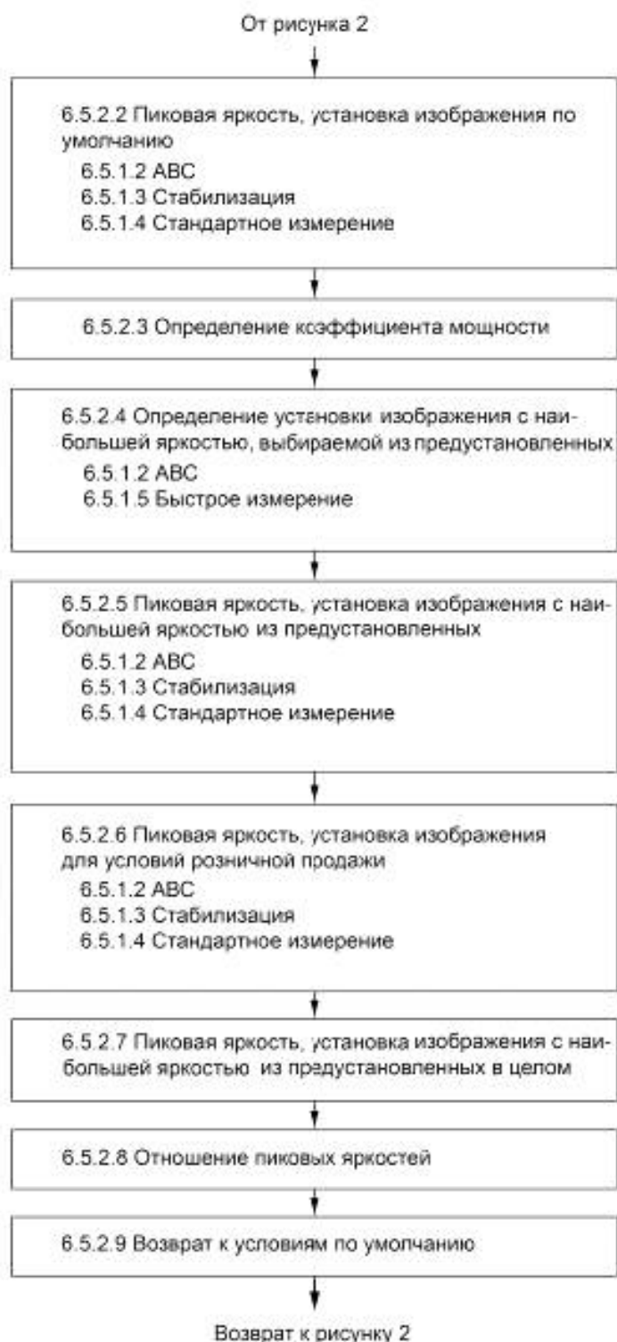
Рисунок 6 — Последовательность действий при определении отношения пиковых яркостей и коэффициента мощности
