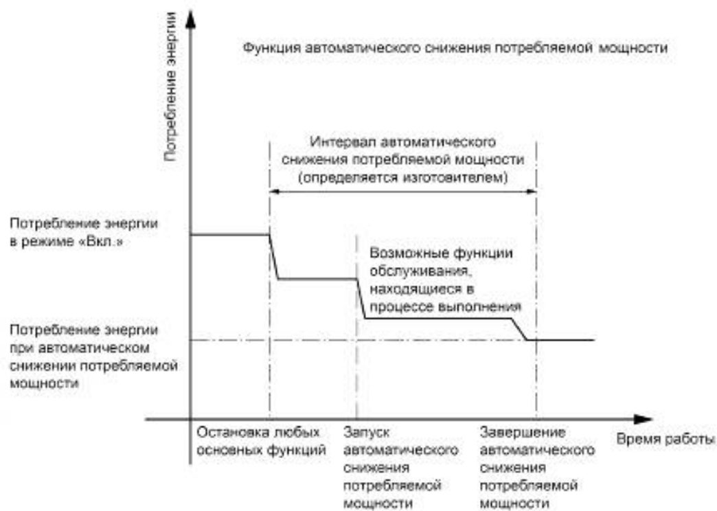
Рисунок 1 — Функция автоматического снижения потребляемой мощности
