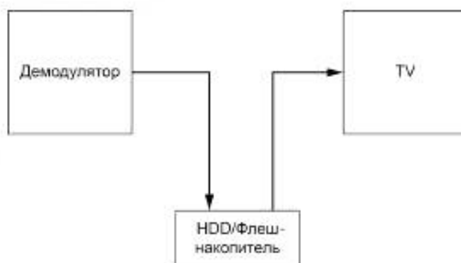
Рисунок А.2 — Запись с временной задержкой с единичным тюнером
