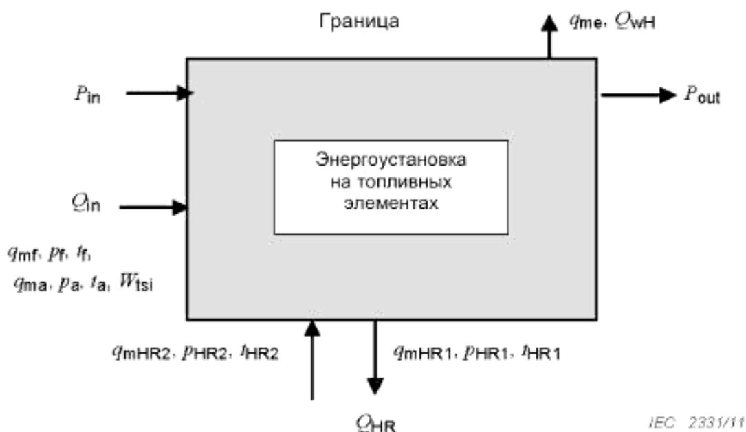
Рисунок 2 - Схема.
