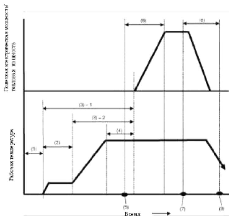
(1) - холодное состояние (останов) - температура окружающей среды в при нулевой потребляемой мощности;
