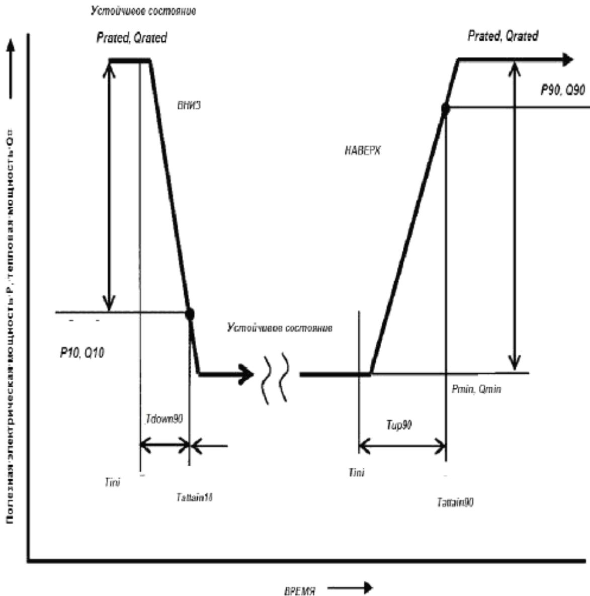
$P_{rated}, Q_{rated}$  - номинальная выходная электрическая мощность и номинальная выходная тепловая мощность, соответственно;
