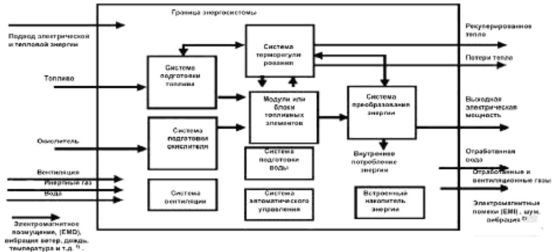
**Рисунок 1 - Схема энергосистемы на топливных элементах**
