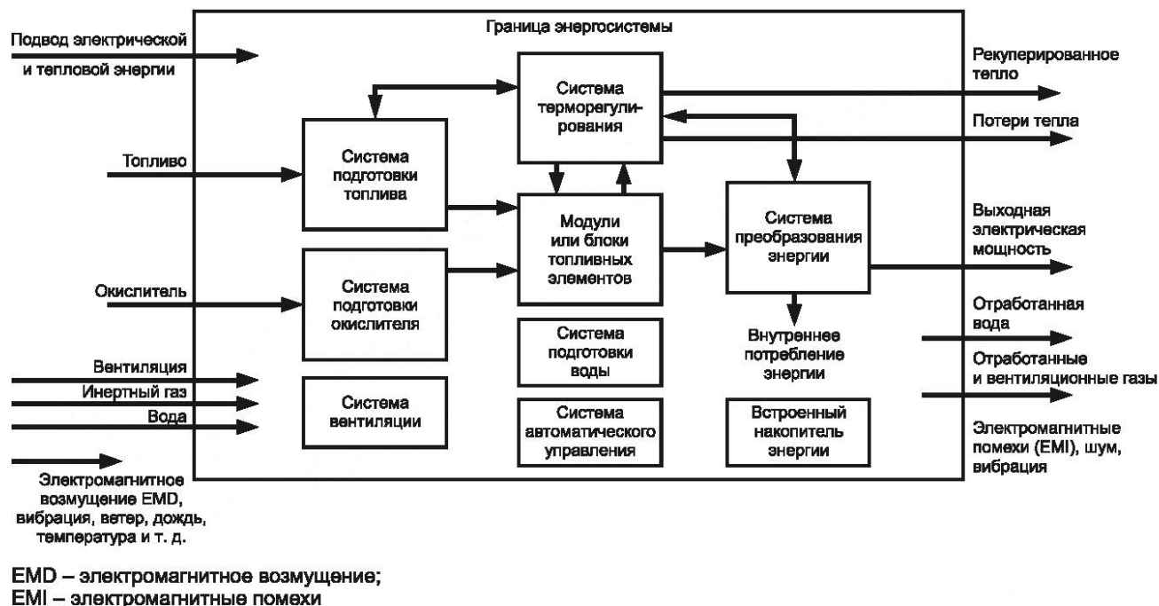
Рисунок 1 — Энергоустановка на топливных элементах
