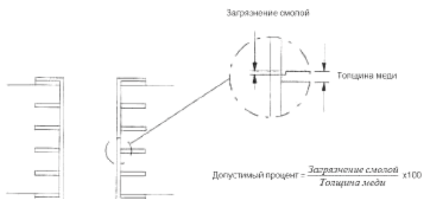
Рисунок 1 – Загрязнение смолой на поверхности раздела
