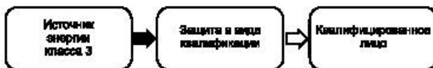
Рисунок 18 — Модель защиты квалифицированного лица от воздействия источника энергии класса 3
