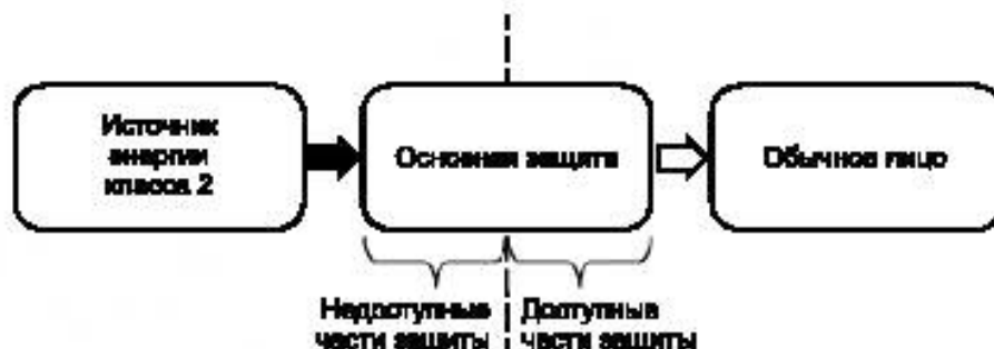
Рисунок 20 — Изображение доступных и недоступных частей основной защиты
