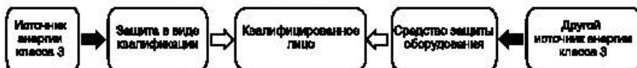
Рисунок 19 — Модель защиты квалифицированного лица от воздействия источников энергии класса 3 при эксплуатации
