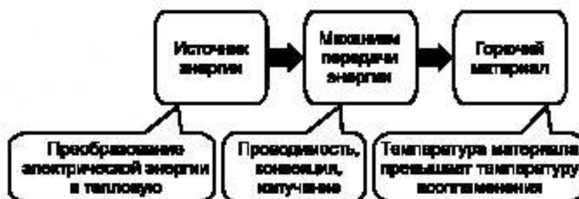
Рисунок 5 — Модель возникновения возгорания при воздействии электричества
