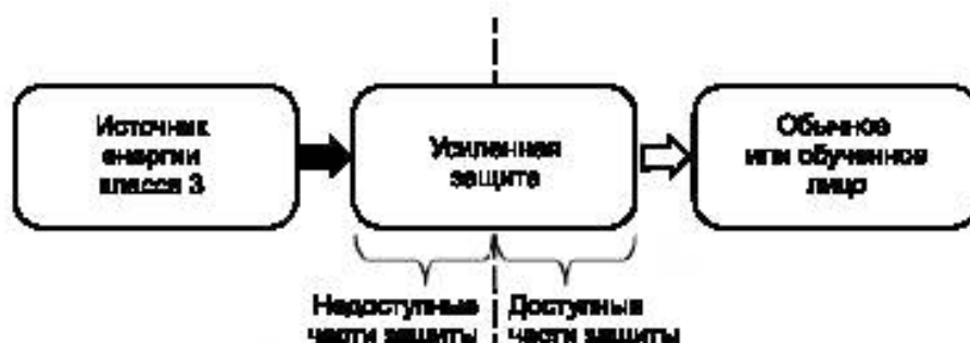
Рисунок 22 — Изображение доступных и недоступных частей усиленной защиты
