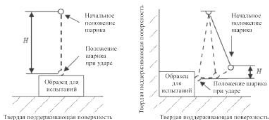
Рисунок Т.1 — Испытание на удар с помощью шарика
