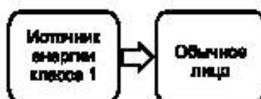
Рисунок 9 — Модель защиты обычного лица от воздействия источника энергии класса 1
