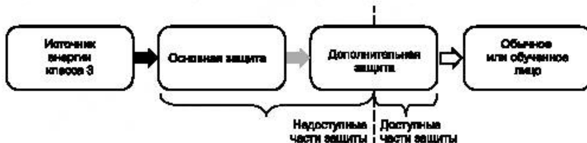
Рисунок 21 — Изображение доступных и недоступных частей дополнительной защиты
