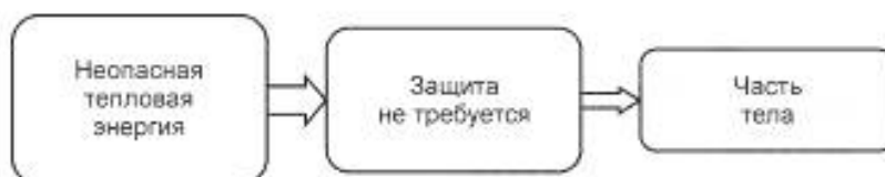
Рисунок 22 — Модель защиты в условиях отсутствия термической опасности
