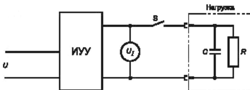
б) Схема для измерения тока с включенным нагрузкой при установившемся режиме работы устройства управления
