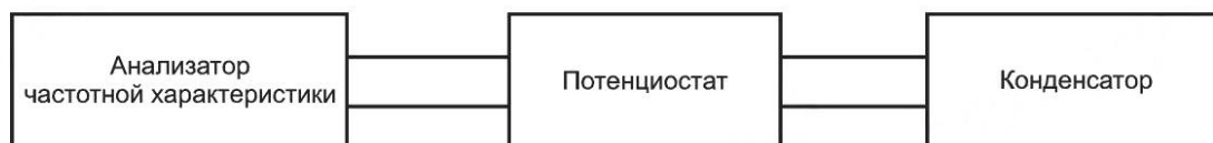
Рисунок В.1 — Система измерения емкости методом переменного тока на низкой частоте
