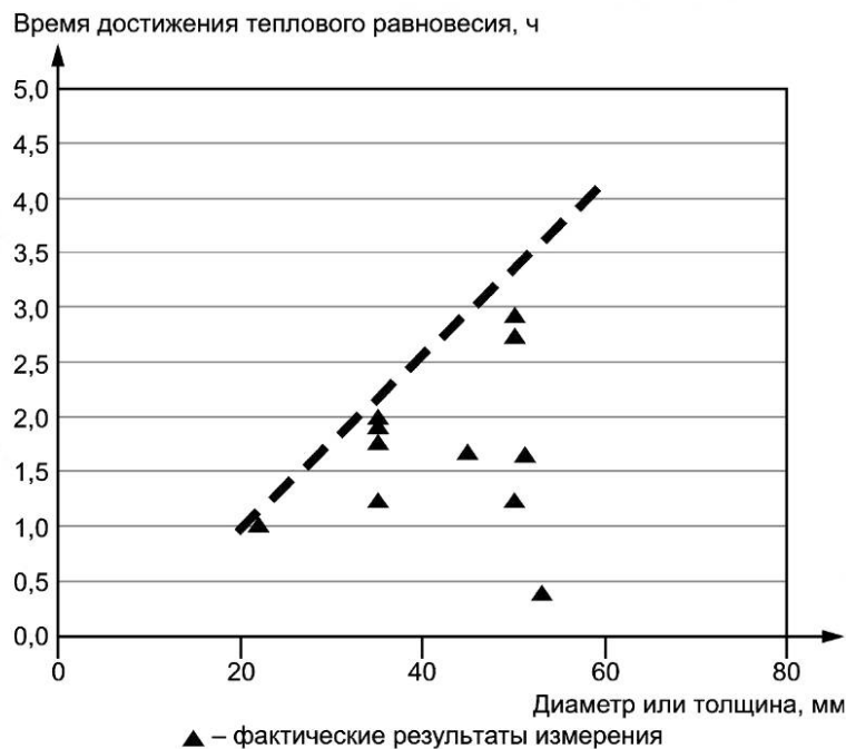
Рисунок С.1 — Длительность достижения теплового равновесия конденсаторов (от 85 °С до 25 °С)
