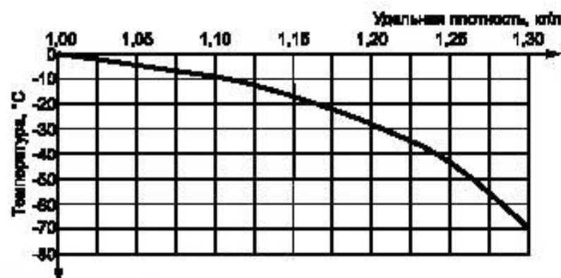
Рисунок 5 — График зависимости температуры замерзания от удельной плотности электролита из раствора гидроксида калия
