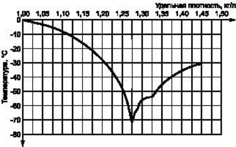
Рисунок 4 — График зависимости температуры замерзания от удельной плотности электролита из раствора серной кислоты
