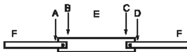
A-B, C-D — точки измерения сопротивления контактных соединений; E — сплошной проводник или многопроволочный витой проводник, соответствующий МЭК 62561-2; F — проводник системы молниезащиты, соответствующий МЭК 62561-2
