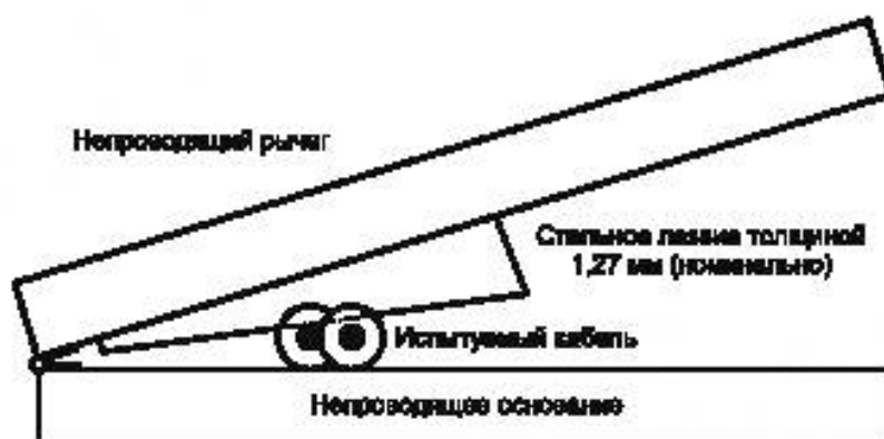
Рисунок 8 — Испытательное устройство для повреждения кабеля
