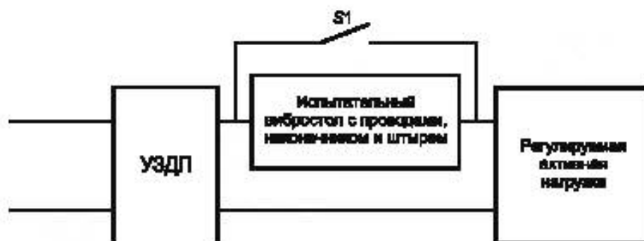
Рисунок F.3 — Соединение УЗДТ с вибростолом при испытании
