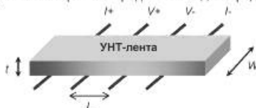
Рисунок 4 — Схема проведения измерений четырехэлектродным методом
