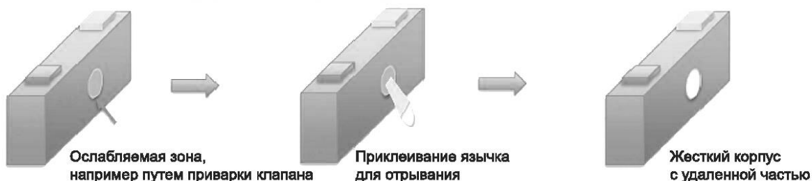
Рисунок С.4 — Пример метода удаления части жесткого корпуса при изготовлении аккумулятора
