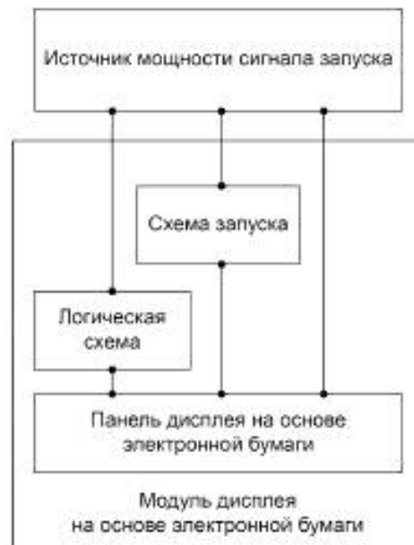
Рисунок 4 — Пример блок-схемы дисплейной панели или модуля на основе электронной бумаги
