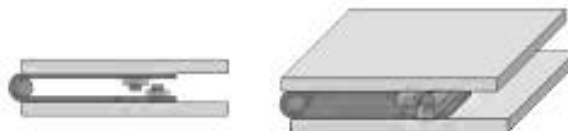
Рисунок 2 — Устройство для испытания на статический изгиб
