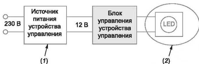
а — Пример схемы для лампы со светоизлучающими диодами с внешним устройством управления
