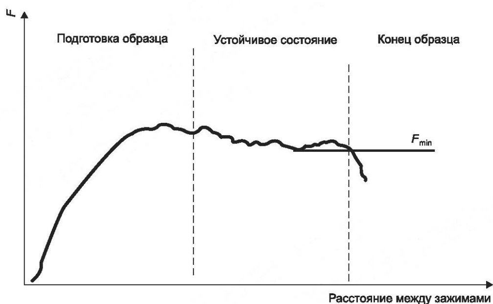
Рисунок D.5 — Типовой график зависимости прочности от расстояния между зажимами (вариант 2)
