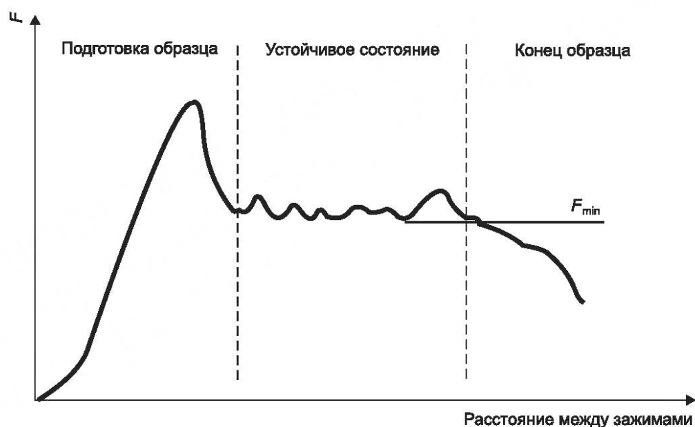
Рисунок D.4 — Типовой график зависимости прочности от расстояния между зажимами (вариант 1)
