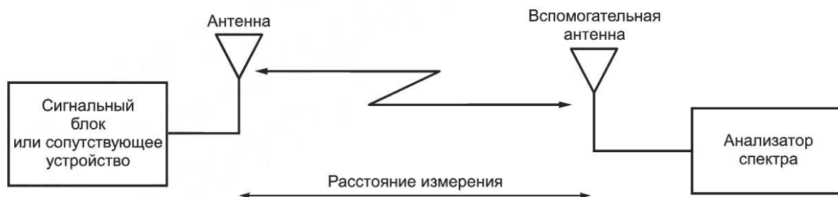
Рисунок 3 — Блок-схема измерительной установки для измерения мощности в неактивном режиме изделия со встроенными антеннами
