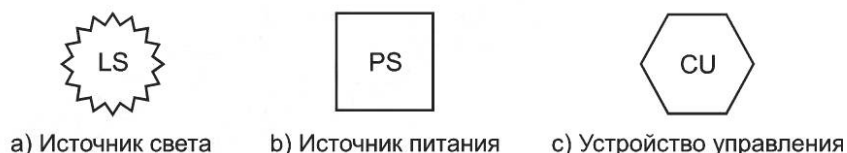
Рисунок 4 — Символы компонентов изделия, предназначенного только для освещения
