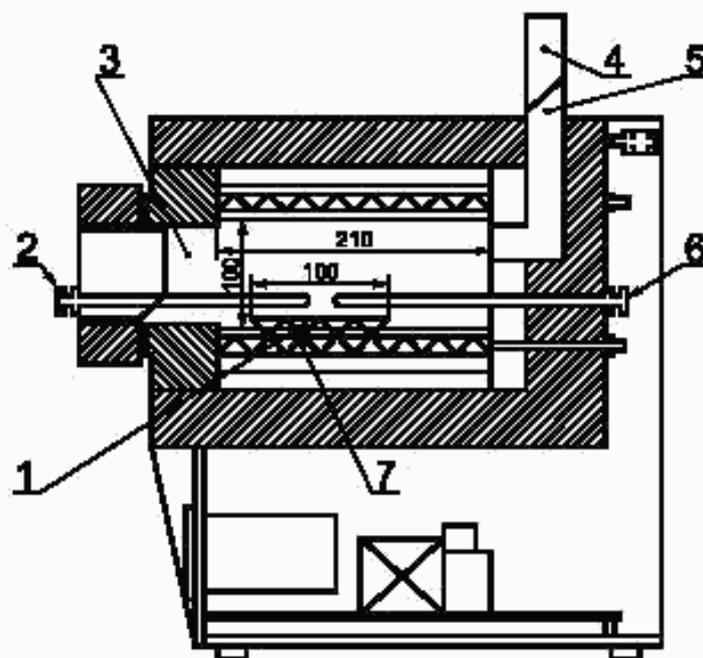
1 — зона постоянной температуры; 2 — контрольная термометра; 3 — камера (ширина 200 мм);
