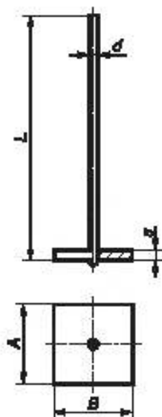
Рисунок А.3.13 — Пластиновый электрод из платины (Изделие № 319)
