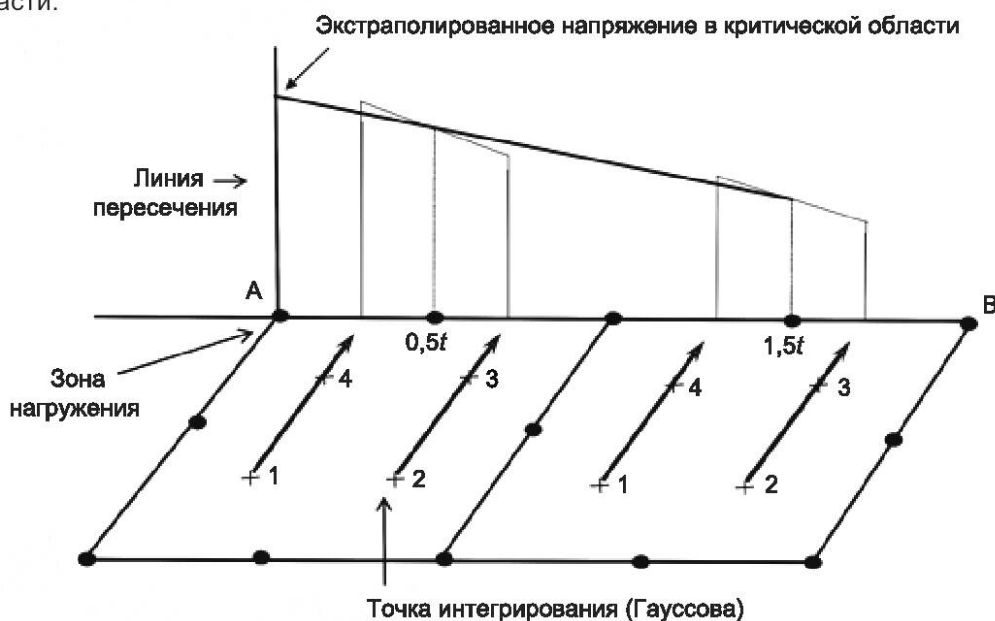
Рисунок 29 — Пример определения напряжений на оболочечной модели
