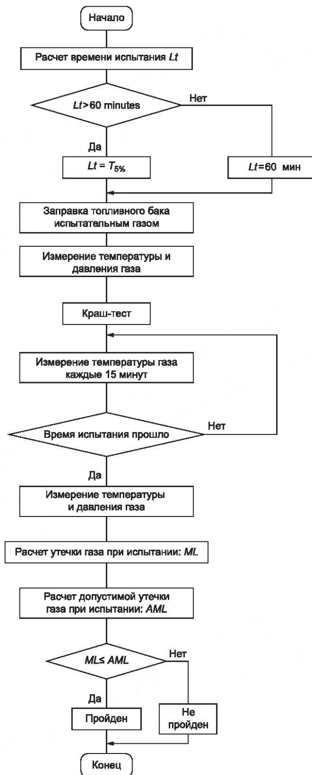
Рисунок А.4 — Алгоритм проведения испытания допустимой утечки
