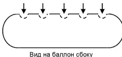
Рисунок Б.2 — Расположение испытательных зон на поверхности баллона
