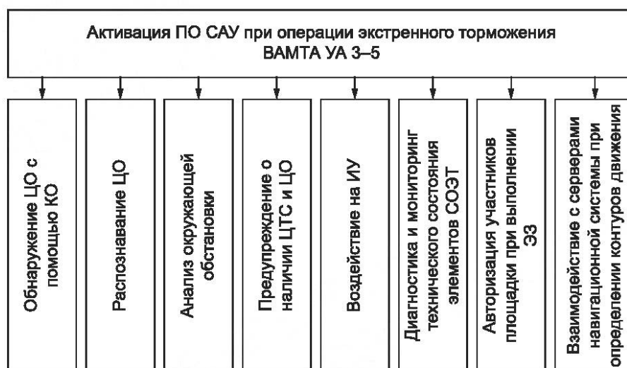
Рисунок Б.1 — Функции ПО САУ при выполнении операции опережающего экстренного торможения ВАМТА УА 3—5
