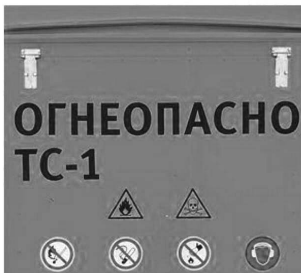
Рисунок 2 — Пример нанесения знаков безопасности на топливозаправщике
