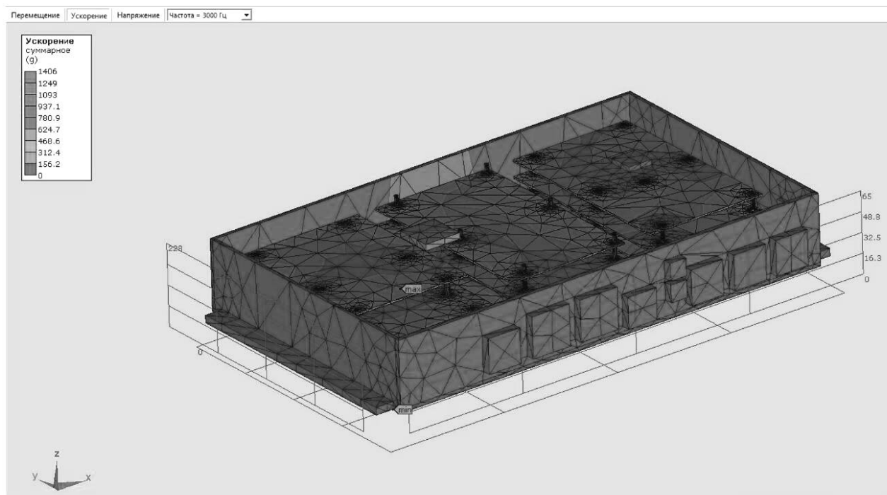
Рисунок А.7 — Суммарные ускорения во всех точках конструкции блока ЭА на резонансной частоте
