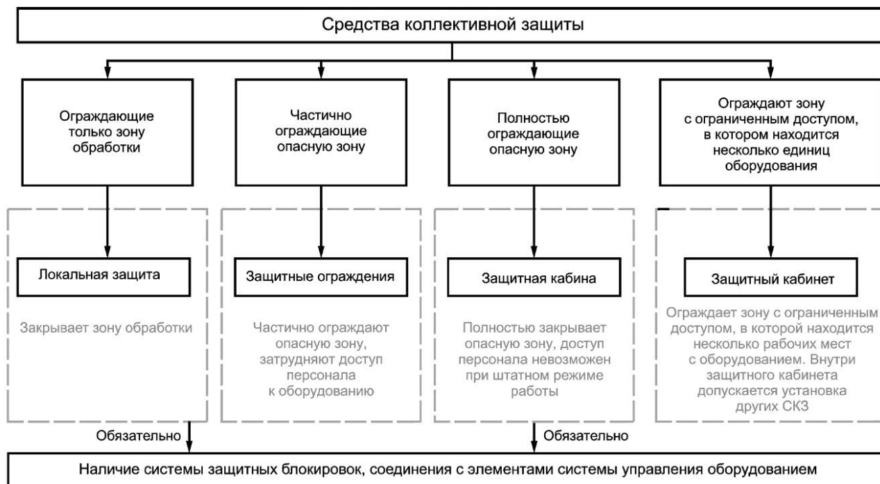
Рисунок Б.1 — Классификация средств коллективной защиты в виде схемы
