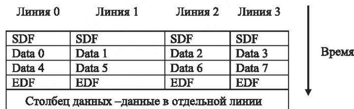
Рисунок 9.4 — Распределение данных по линку мультилинии
