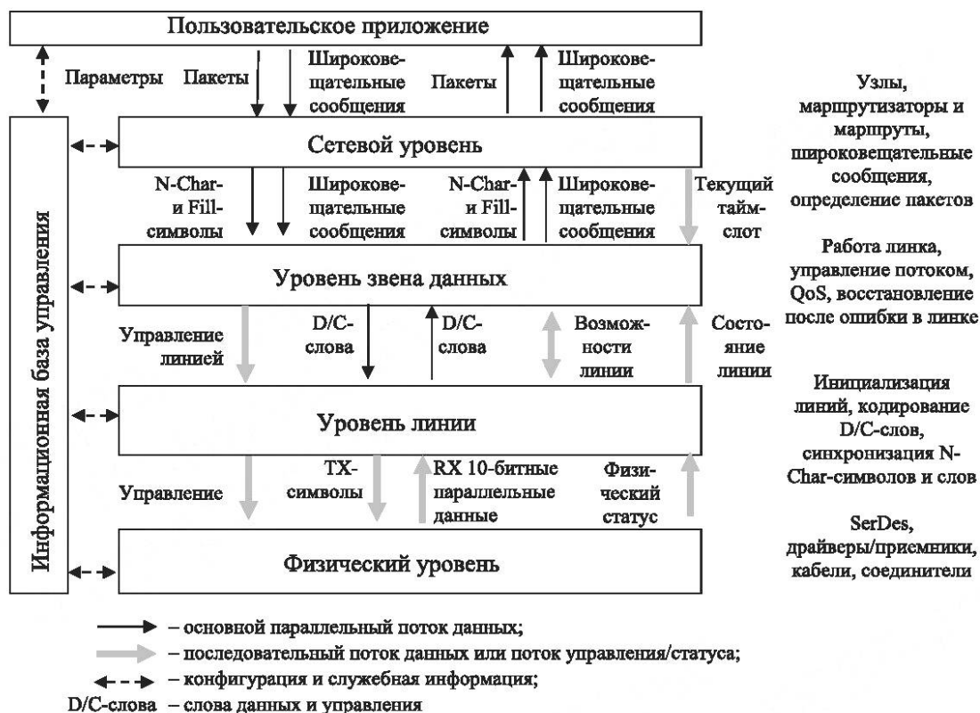
Рисунок 5.1 — Стек протоколов SpaceFibre-RUS для линка с одной линией передачи
