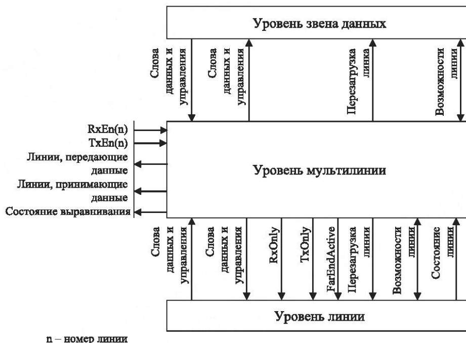
Рисунок 9.1 — Интерфейсы уровня мультилинии
