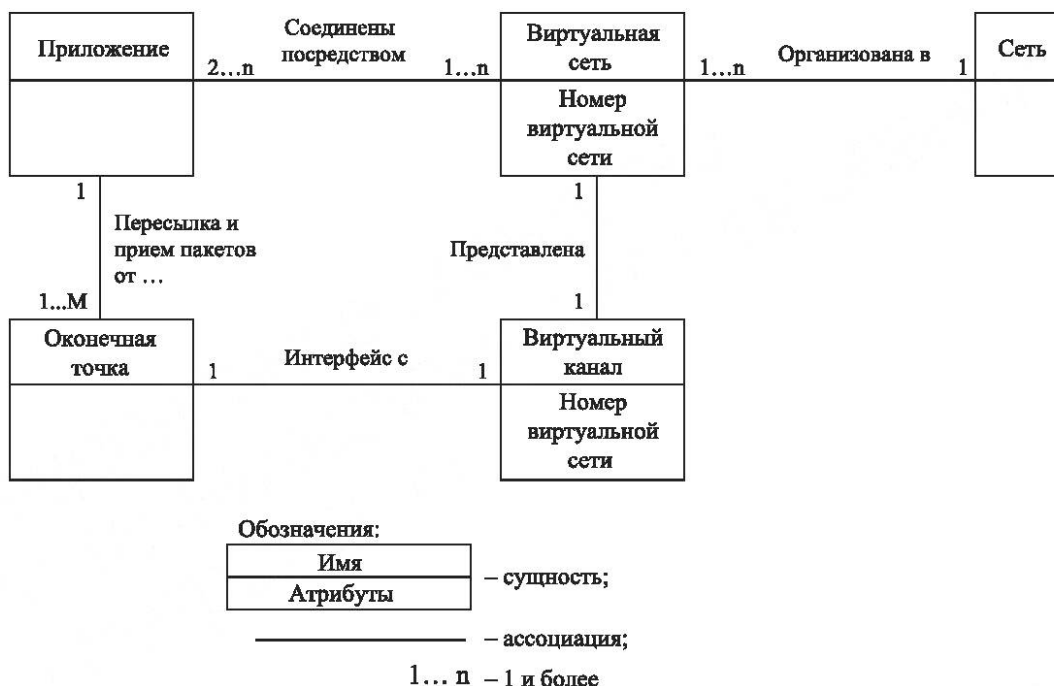
Рисунок 11.3 — Связи внутри виртуальной сети SpaceFibre
