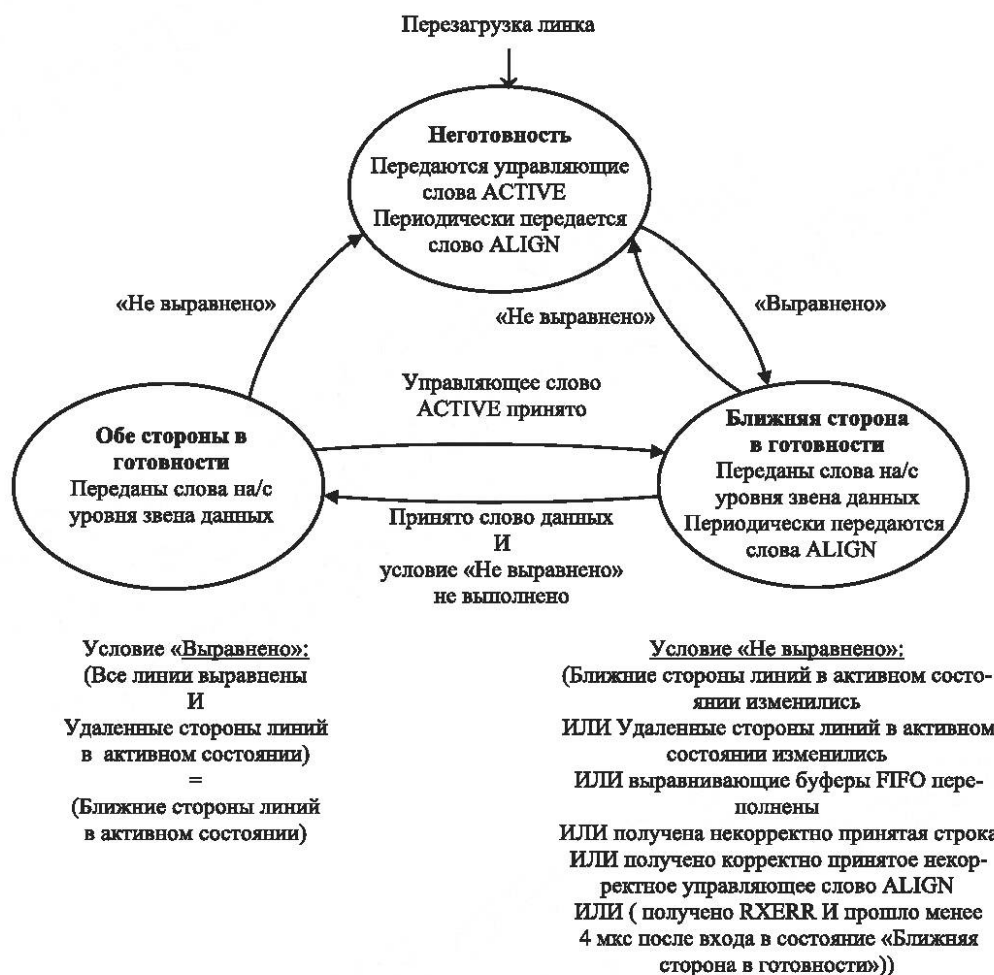
Рисунок 9.7 — Диаграмма состояний машины состояний выравнивания
