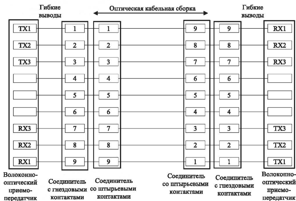
Рисунок 7.17 — Волоконно-оптическая летная кабельная сборка В-типа с несколькими линиями
