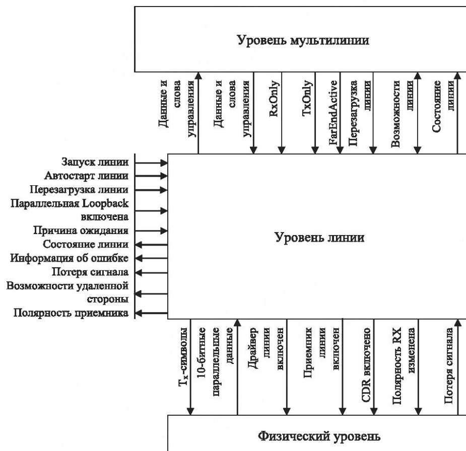
Рисунок 8.2 — Интерфейсы уровня линии для линка с мультилинией
