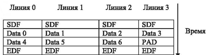
Рисунок 9.5 — Пример использования слова PAD в линке мультилинии
