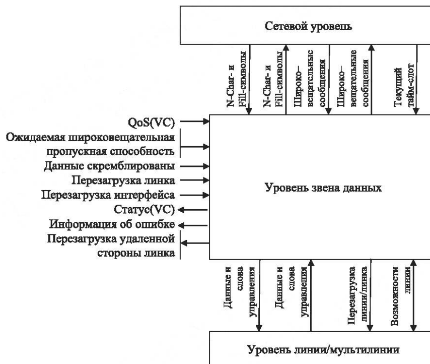
Рисунок 10.1 — Интерфейсы уровня звена данных
