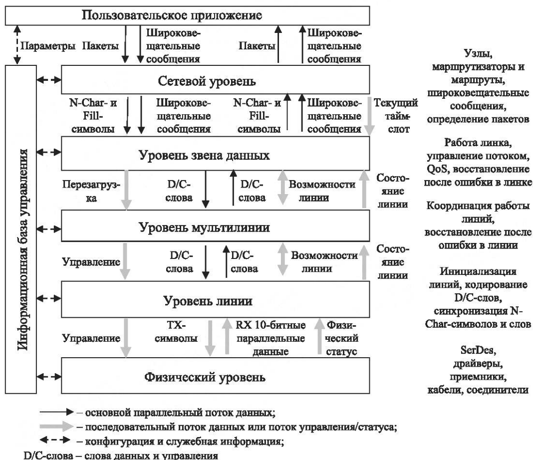
Рисунок 5.2 — Стек протоколов SpaceFibre-RUS для линка с мультилинией
