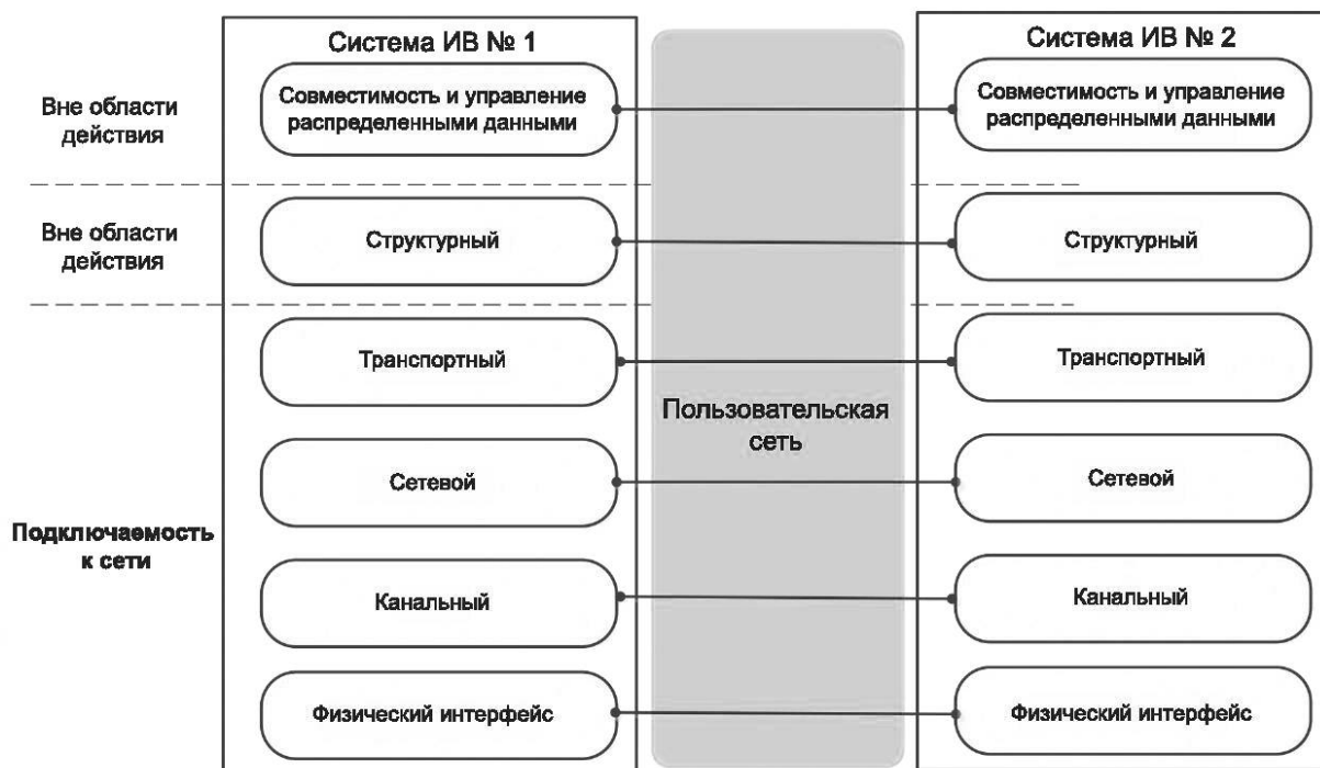
Рисунок 4 — Модель стека подключаемости сети между системами ИВ
