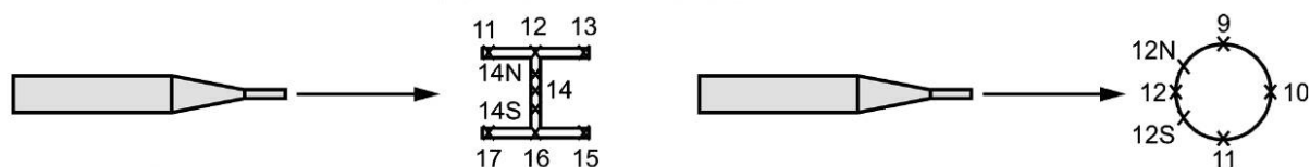
Рисунок Т.3 — Ориентация струи относительно термопар в месте соударения с балкой и с трубой
