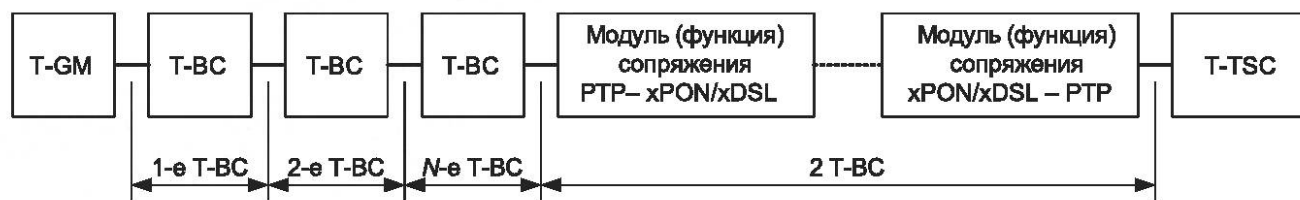
Рисунок Г.6 — Модель цепи синхронизации, включающей участок с оборудованием xPON или xDSL
