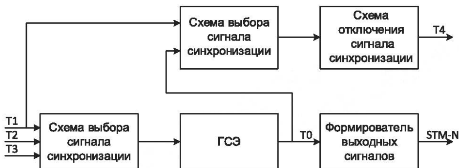
Рисунок 1 — Схема распределения сигнала синхронизации в мультиплексоре СЦИ
