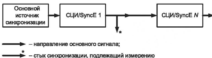
Рисунок 1 — Схема измерений параметров синхронизации по пункту 1 таблицы 1
