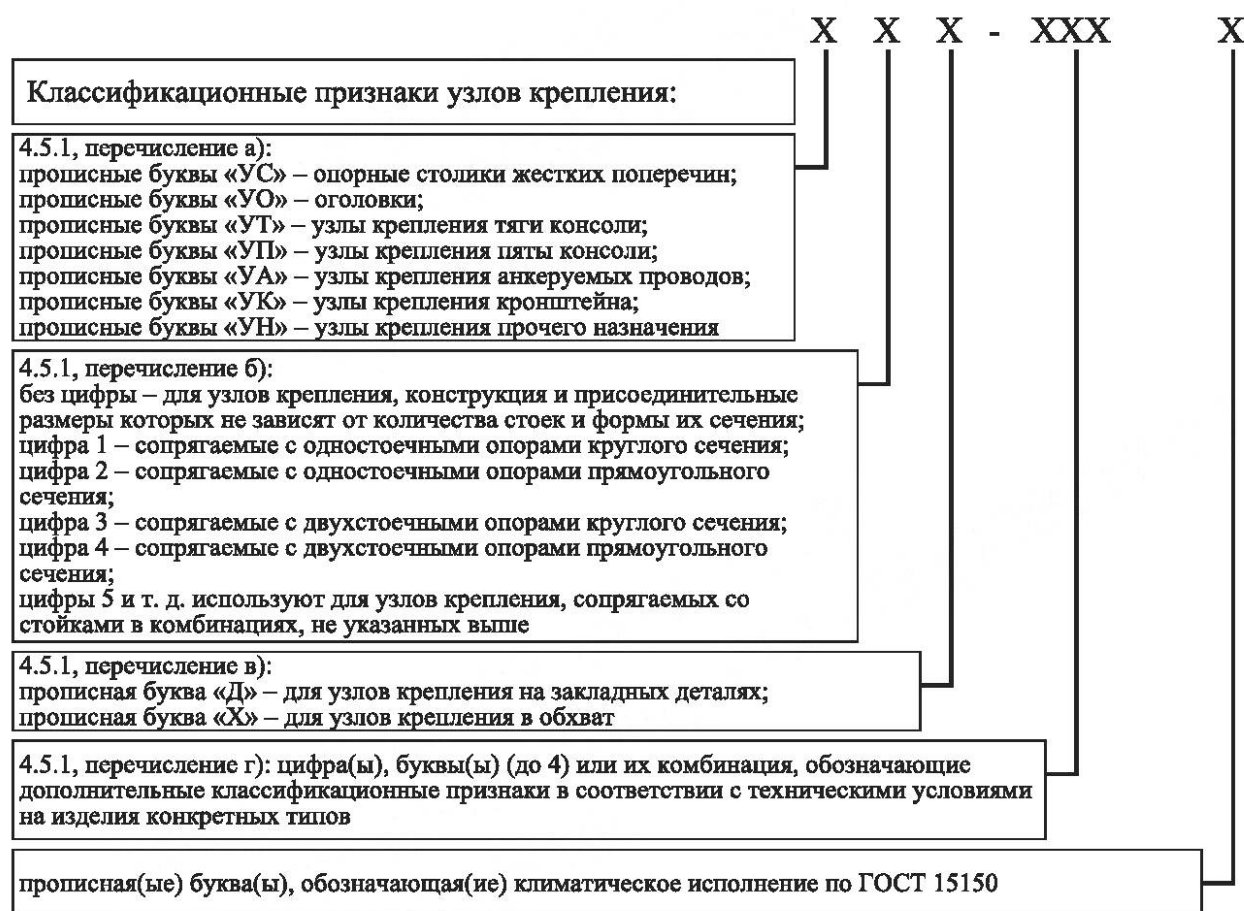
Рисунок 16 — Структурная схема условного обозначения узла крепления
