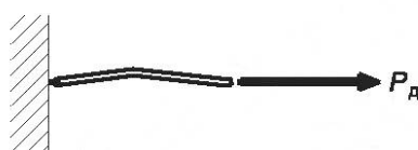
в) схема приложения нагрузки к дополнительному стержню
