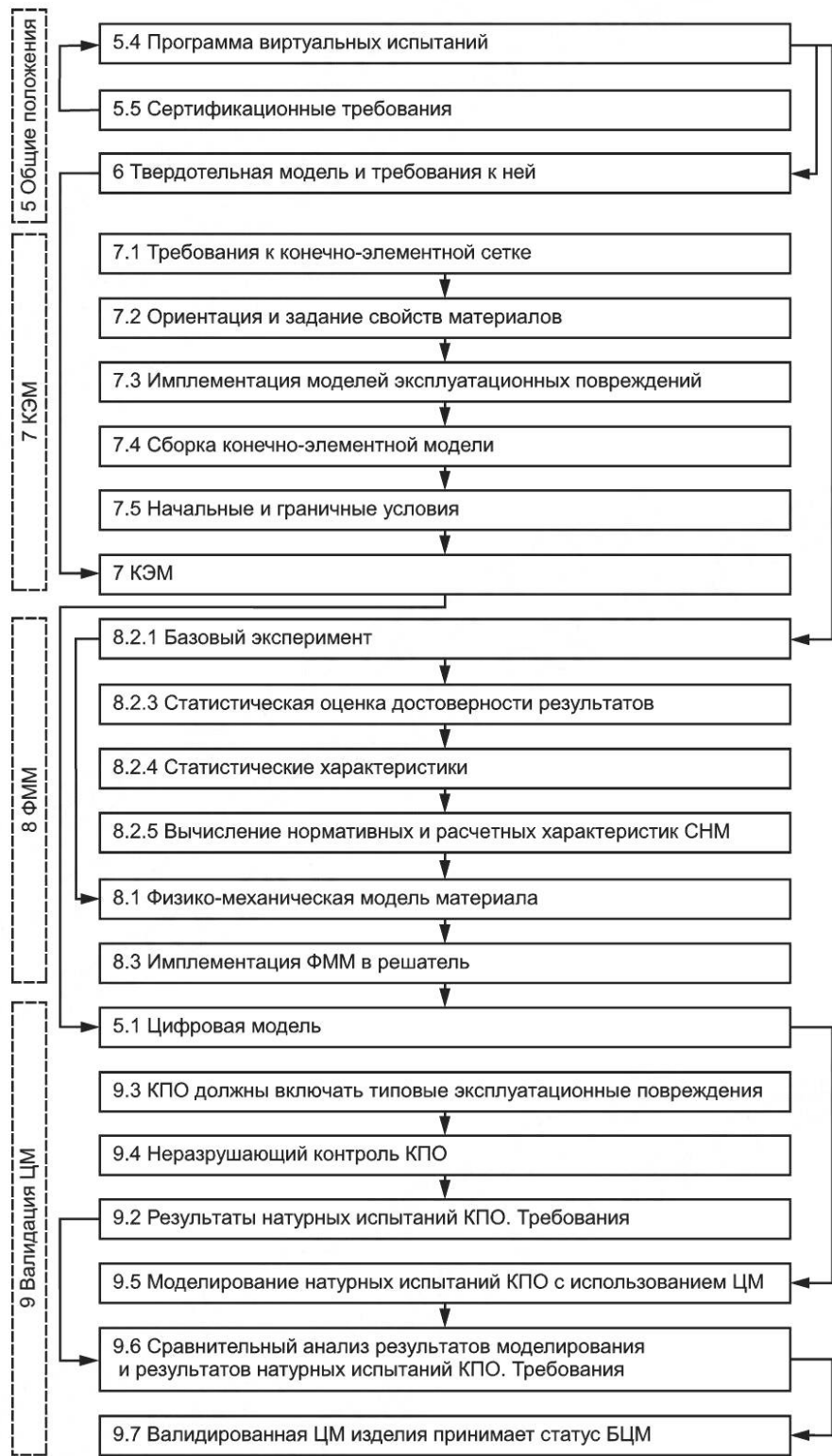
Рисунок А.1 — Схема создания цифровой модели изделия
