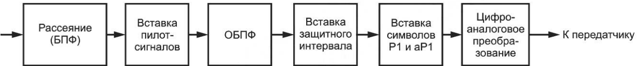
Рисунок 7 — Структурная схема блока генерации SC-OFDM
