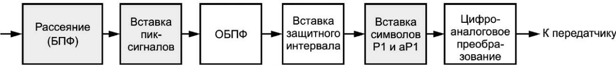
Рисунок 5 — Структурная схема генерации SC-OFDM
