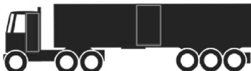
Рисунок Б.1 — Схема шестисосного седельного автопоезда (трехосный седельный тягач с полуприцепом)
