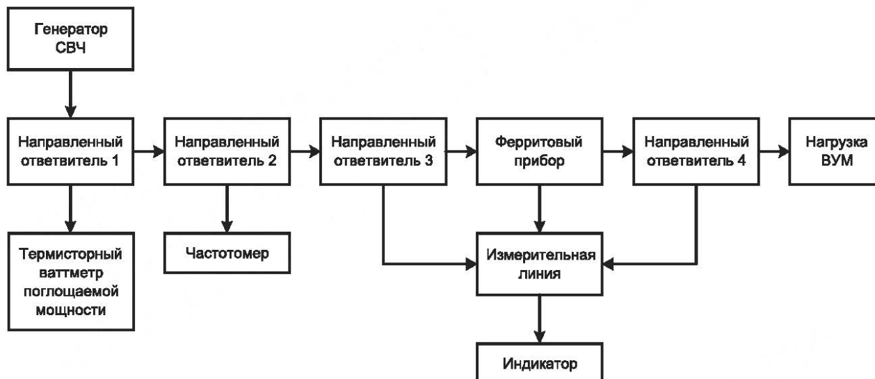
Рисунок 1 — Структурная схема установки для измерения фазового сдвига на высоком уровне мощности методом I
