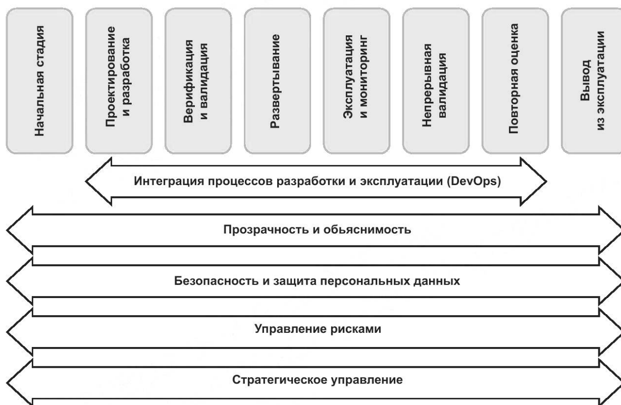
Рисунок 2 — Пример стадий и высокоуровневых процессов в модели жизненного цикла системы ИИ
