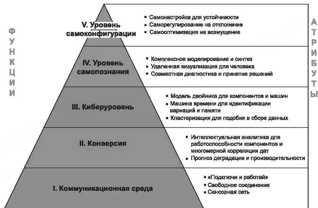
Рисунок 2 — 5-уровневая архитектура КФС
