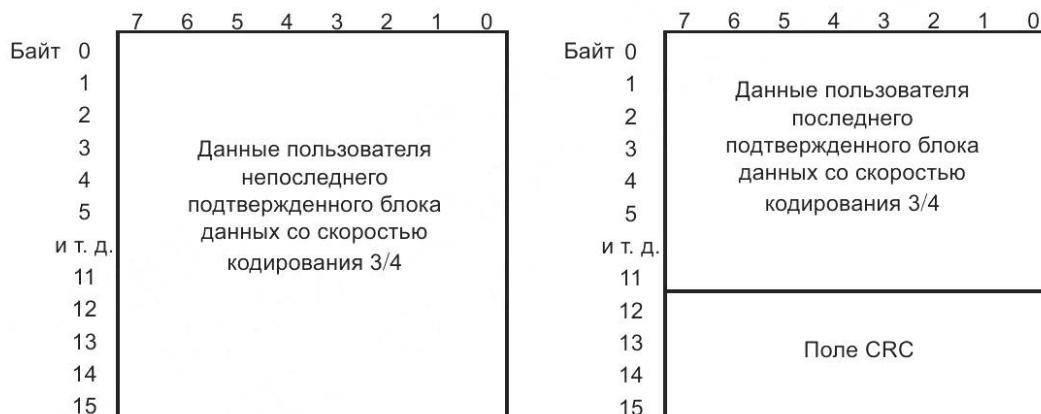
Рисунок Б.12 — Порядок размещения пользовательских данных и поля CRC для пакетов «Продолжение данных FEC со скоростью кодирования \frac{3}{4} » и «Последний блок данных FEC со скоростью кодирования \frac{3}{4} »
