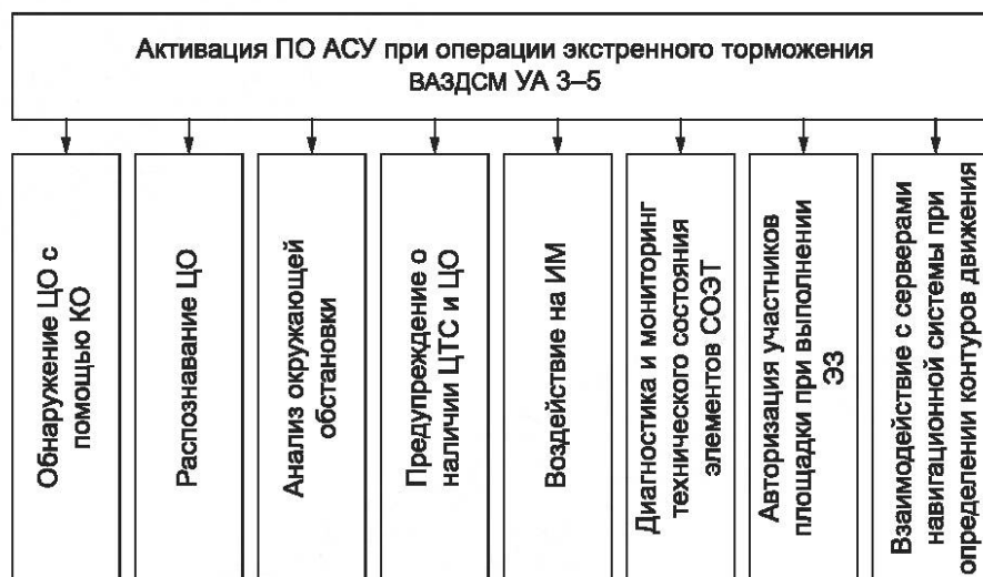
Рисунок Б.1 — Функции ПО АСУ при выполнении операции опережающего экстренного торможения ВАЗДСМ УА 3-5
