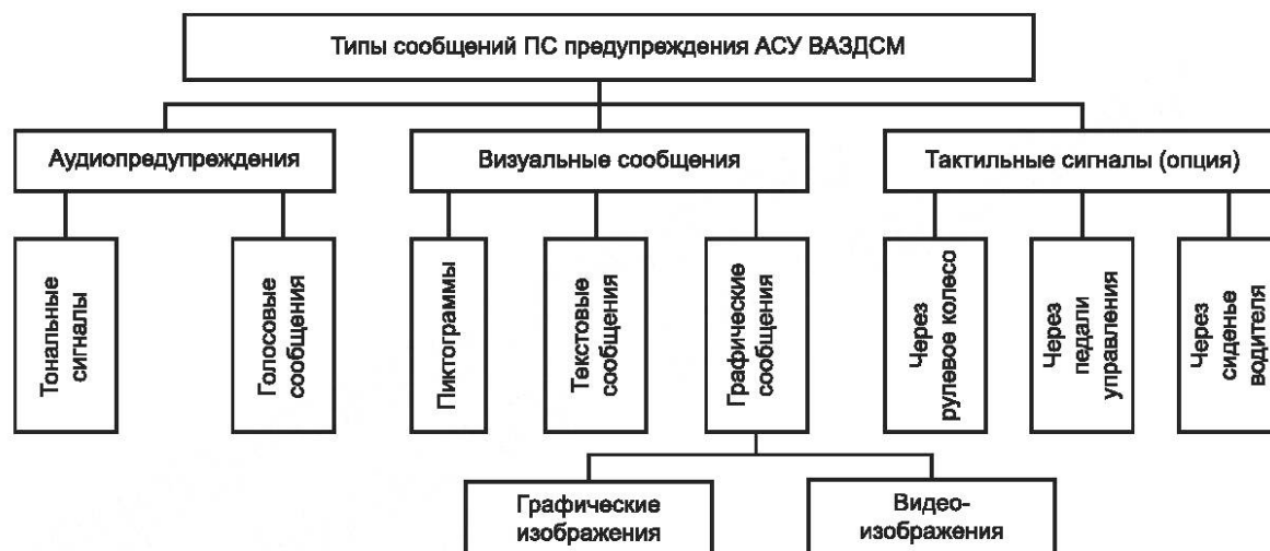
Рисунок 7 — Типы сообщений подсистемы предупреждения для оператора ВАЗДСМ УА 0—5
